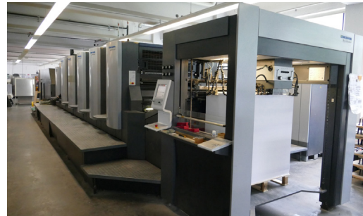
Die beiden großformatigen Heidelberg-Druckmaschinen aus den Jahren 2021 und 2018 bilden die Highlights im Drucksaal von RCDruck. Links die Heidelberg Speedmaster CX 104-4+L, rechts die Heidelberg Speedmaster CX 102-5+L.
